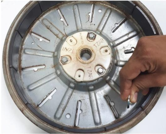
**Figura 13:** O rotor do gerador e uma análise da quantidade de polos com um pequeno ímã de neodímio.
