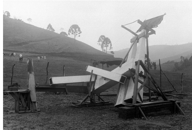
Figura 4: Conjunto de cámaras gemelas diseñadas y construidas en el Observatorio Nacional Argentino, destinadas a realizar las fotografías para medir la desviación de la luz en oportunidad del eclipse solar del 10 de octubre de 1912, instaladas en Cristina. Las cámaras estaban montadas sobre un eje polar, el cual soporta también otras dos cámaras destinadas a obtener espectros. En el extremo izquierdo de la imagen se aprecia el sistema de relojería. El diafragma consistía en una tela negra en un sencillo marco de madera. Fuente: APOAC.
