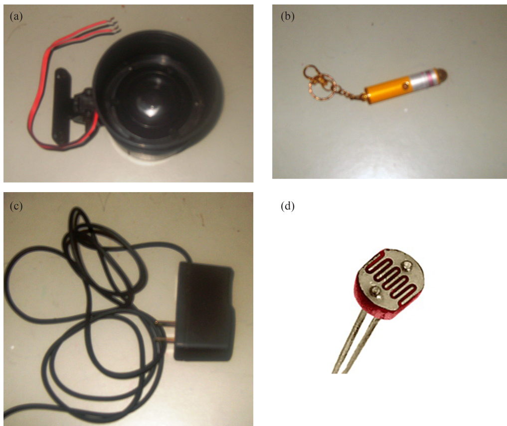
Figura 2 - Materiais utilizados para construção do experimento: (a) sirene (b) ponteira laser (c) carregador de celular (d) LDR [12].
