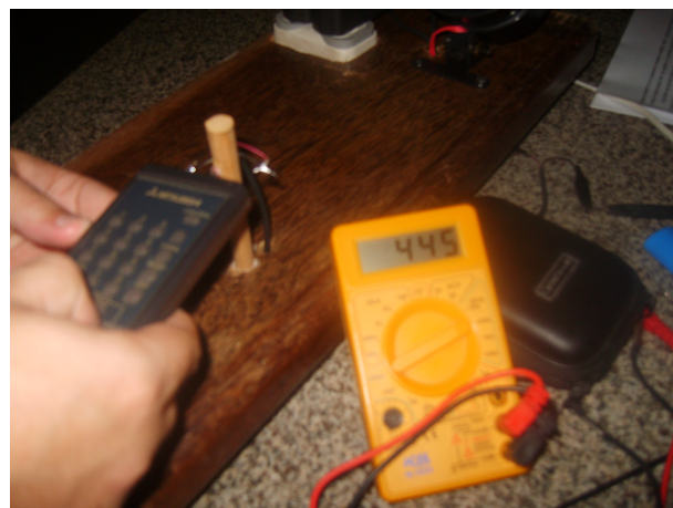
Figura 4 - Corrente elétrica constatada devido à interação de radiação infravermelha com o LDR.
