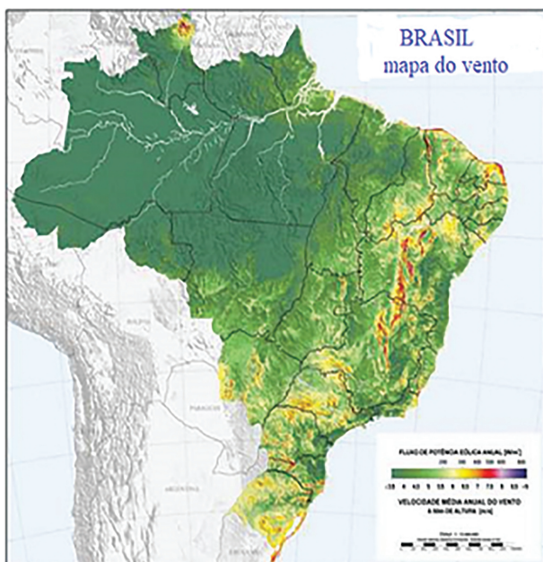
Figura 3: Mapa do vento médio em terras brasileiras, medido à altura de 50 metros.
