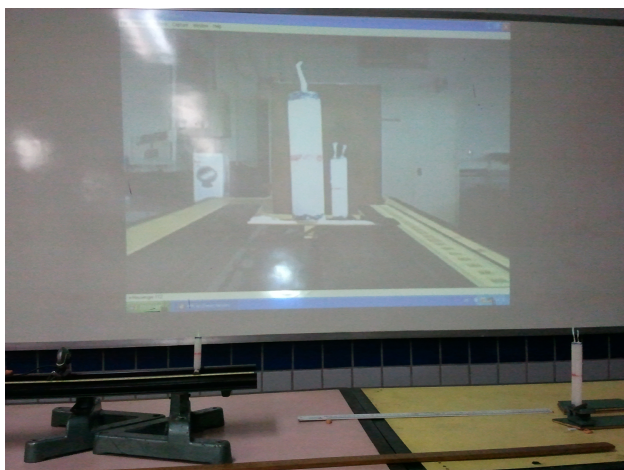
Figura 3: Vemos à esquerda a “vela-objeto” e à direita a “vela-imagem”. A “vela-imagem” tem o dobro da altura e da largura da “vela-objeto”, como previsto pela equação do aumento linear transversal para os parâmetros usados na experiência. Porém, a “vela-imagem” (em segundo plano na projeção da parede) é visualizada com a metade da altura e da largura da “vela-objeto” (em primeiro plano na projeção da parede). Isso ocorre devido ao efeito do ângulo visual.
