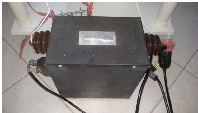
Figura 2: O transformador de neon. Fonte: Os autores.
