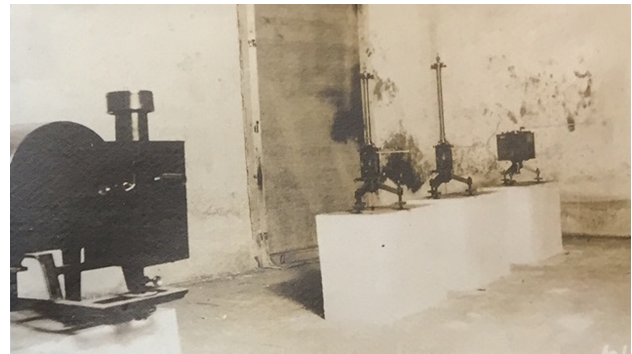
Figura 4: Magnetógrafo e variômetros utilizados por Daniel Wise. Fotografia realizada em 09 de junho de 1919. Cortesia da Carnegie Institution, Department of Terrestrial Magnetism .
