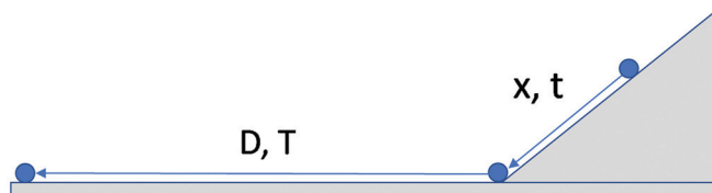
Figura 3: Medida de velocidade com o “velocímetro galileano”. A velocidade instantânea no pé do plano inclinado é dada pela velocidade v = D/T na horizontal.
