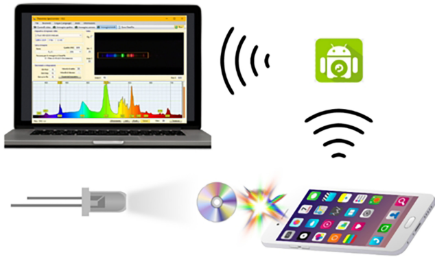
Figura 3: Esquema ilustrativo da montagem experimental adotada na medida do espectro de emissão do LED.
