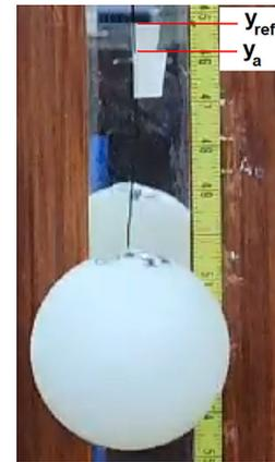
**Figura 4:** Fotografía del sistema c) –  $y_a$ : Posición aparente del punto de referencia.  $y_{ref}$ : Posición del reflejo del punto de referencia.
