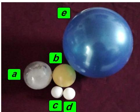
**Figura 1:** Esferas usadas en los sistemas masa-resorte. Las esferas *a*, *b*, y *c* se rellenaron con una mezcla de yeso y arena; la *d*, con agua, y la *e*, con aire comprimido.
