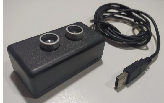
Figura 1: Foto do módulo detector de distância montado.
