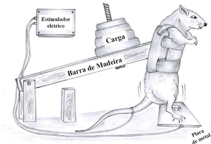
FIGURA 1 - Modelo do aparato de exercício de força.
