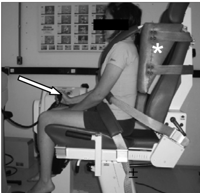
Figura 1. Posicionamento do voluntário na cadeira do dinamômetro: dispositivo (seta) utilizado para iniciar ou parar a avaliação passiva e acessório (*) para manter a articulação do quadril com aproximadamente 90° de flexão.
