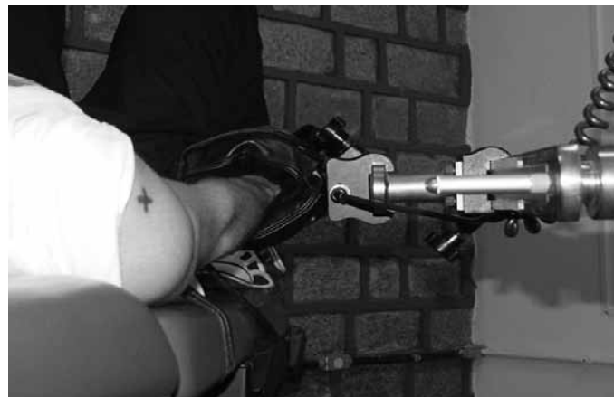
Figura 1. Ponteira laser utilizada no alinhamento dos eixos articular e mecânico.
