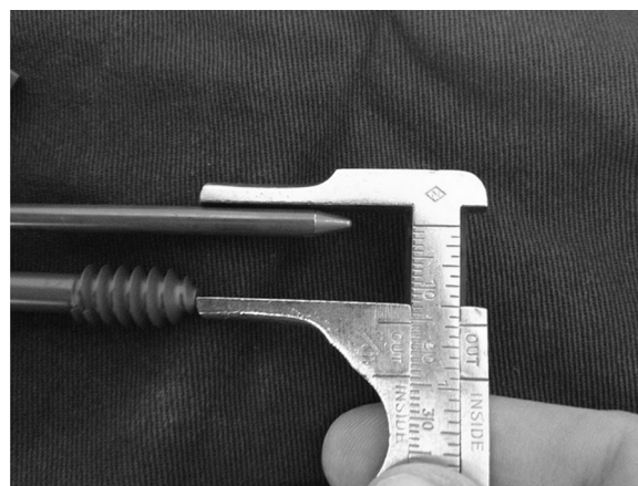
Figura 5 – Medida real de ZX por meio de paquímetro universal.
