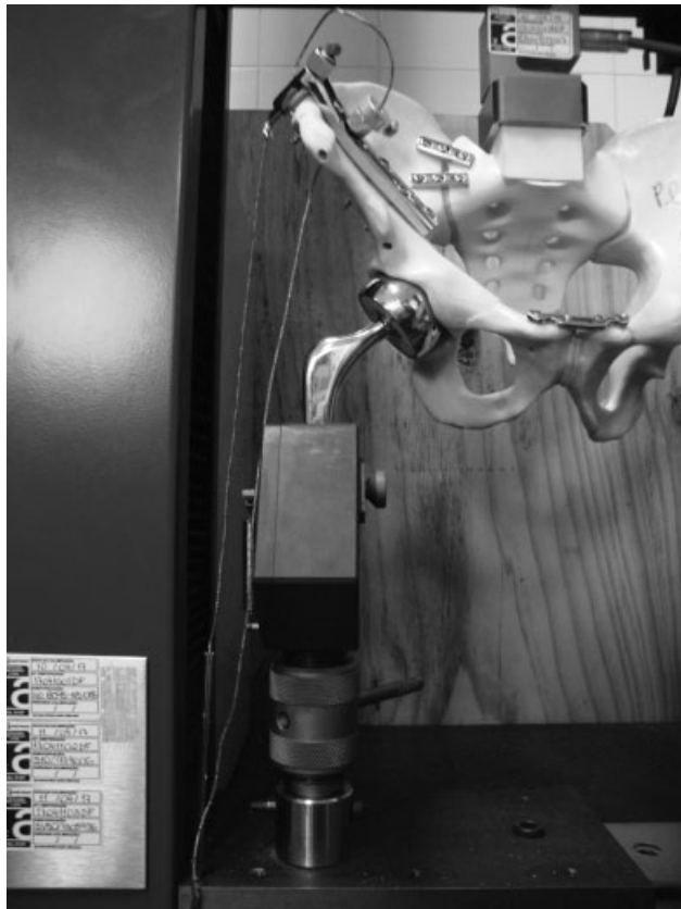
Fig. 4 O íliaco da hemipelve direita ainda foi conectado ao cabeçote inferior da máquina por meio de dois cabos de aço de 1,6 mm de diâmetro substituindo a musculatura glútea para estabilização da pelve. Os cabos foram fixados ao íliaco com o auxílio de uma placa. Um dos cabos foi fixado à altura da crista ilíaca, e o outro sobre a linha glútea anterior, nas proximidades do tubérculo da crista ilíaca. (fonte: arquivo pessoal).
