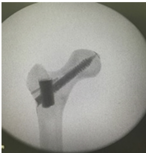
Figura 2 – Imagem de raios X de modelo sintético após reforço com PMMA.
