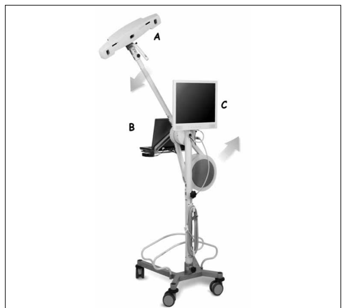
Figura 2 – Navegador com (A) câmera de rastreamento ótico, (B) computador e (C) monitor
