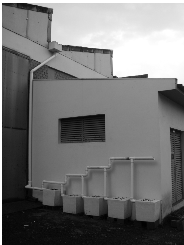
Figura 2. Amostradores de coleta de água de chuva do telhado.
