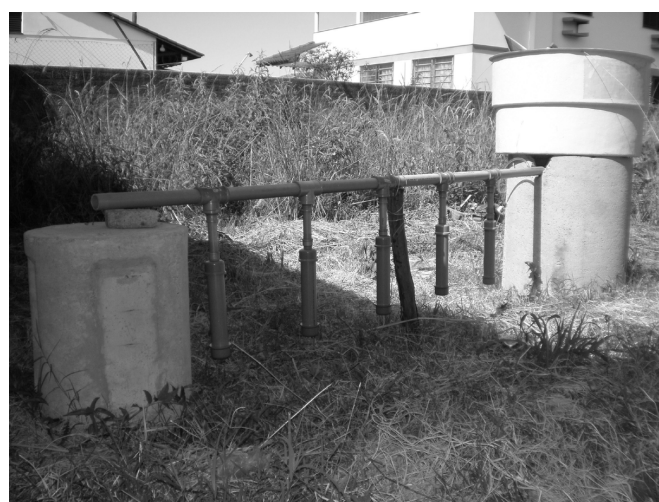
Figura 1. Amostrador de coleta de água de chuva da atmosfera.
