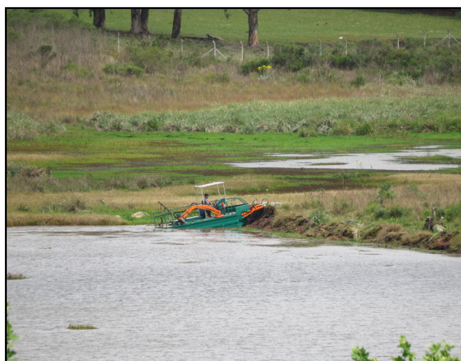
Figura 2a - Barco C96 Waterdozer CONVER® transferindo as plantas aquáticas de agrupamentos para margens secas do reservatório
