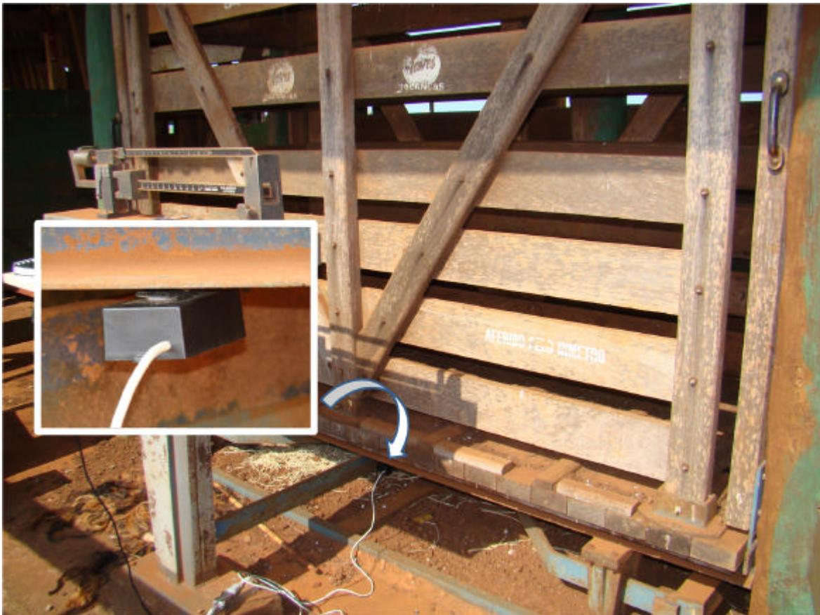
Figura 1 - Dispositivo eletrônico utilizado no teste de reatividade animal em ambiente de contenção móvel – REATEST® para determinar a reatividade do animal.
