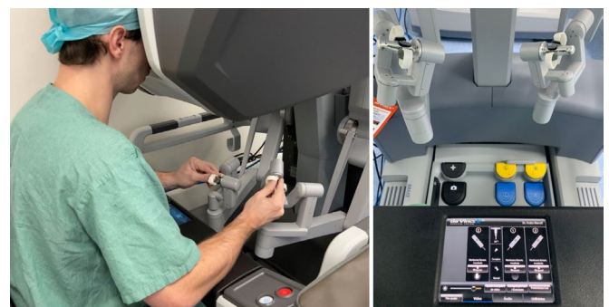
Figura 6. Console Da Vinci e interatividade do cirurgião, com visualização binocular, instrumentos e pedais.
