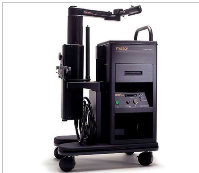
Figura 1. AESOP (sistema endoscópico automatizado para posicionamento ideal).
