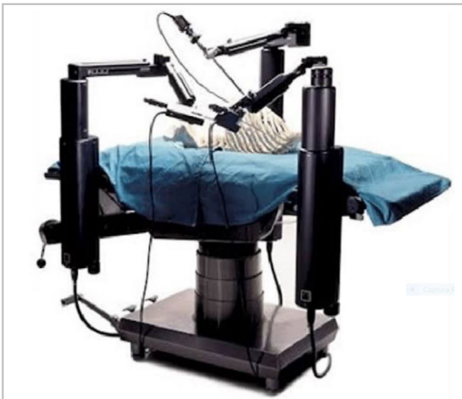
Figura 2. O robô ZEUS consistia em três braços.
