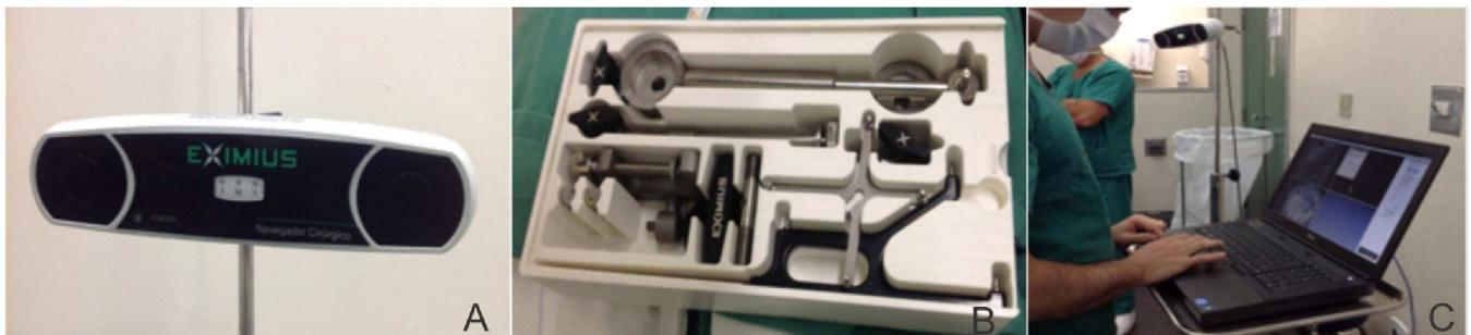
**Figura 3** - Componentes do sistema EXIMIUS: A) câmera; B) instrumentos; e C) computador com plataforma de navegação.
