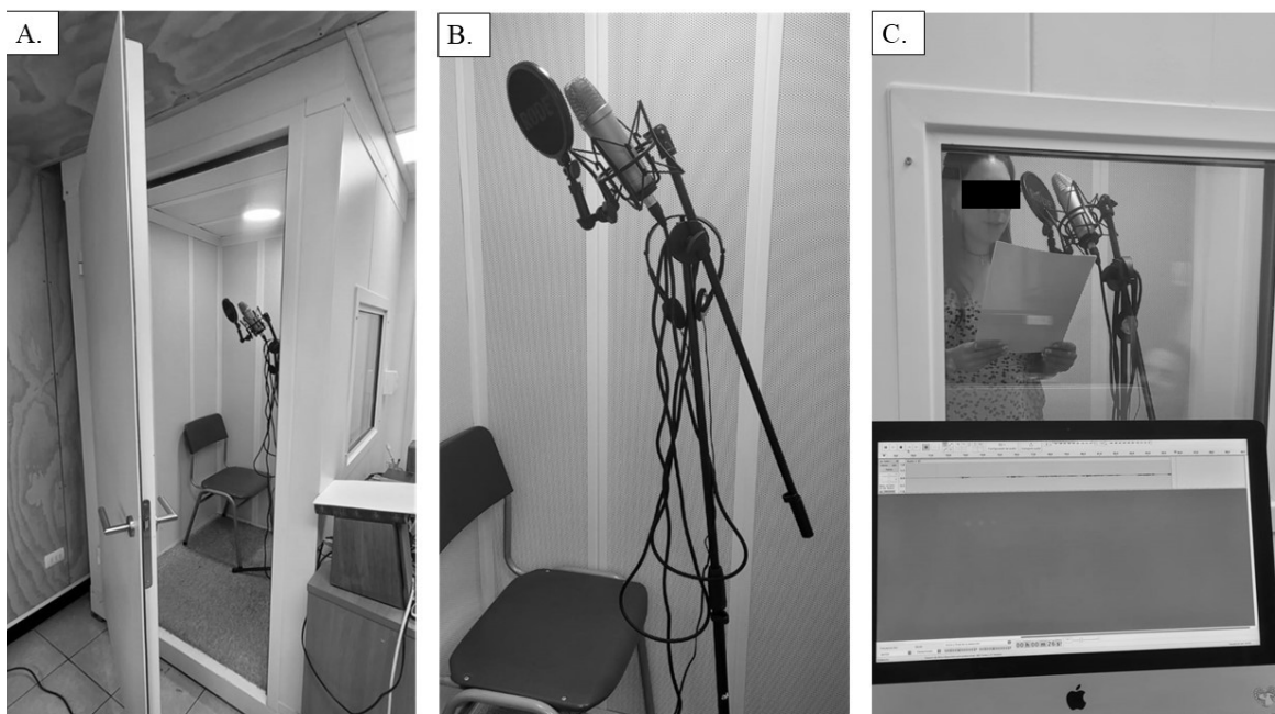
Figura 1. Equipos utilizados para la grabación de audio en el Laboratorio de Fonética USACH. A. Cámara silente; B. Micrófono modelo RØDE NT1-A ; C. Grabación de muestra de audio con el programa Audacity versión 3.1.3 para Mac
