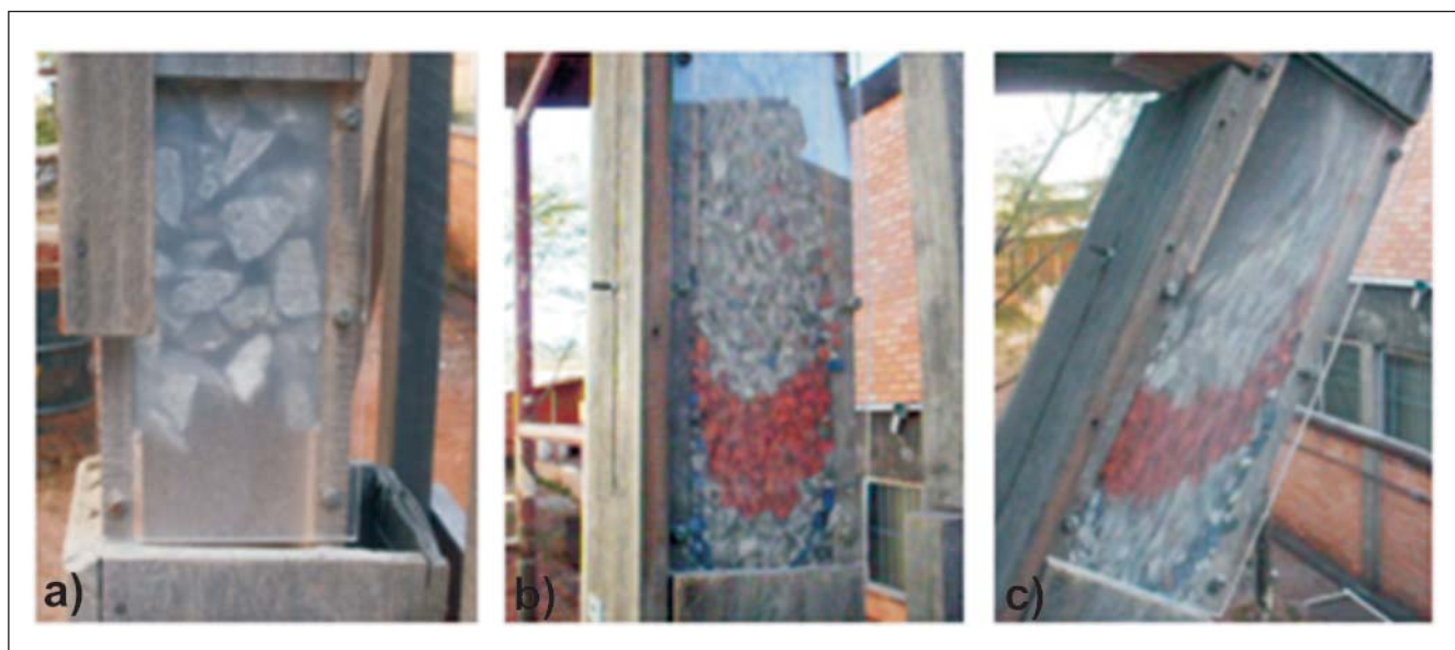
Figura 5 - Efeitos observados nos ensaios: a) arcos mecânicos, b) fluxo em funil e c) fluxo turbulento.
