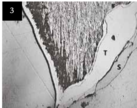
Figure 3 Fotomicrografia, em luz refletida do meteorito João Pinheiro, exibindo plessita duplex com borda de taenita (T) bem desenvolvida, em contato com schreibersita (S) (escala = 100µm).
