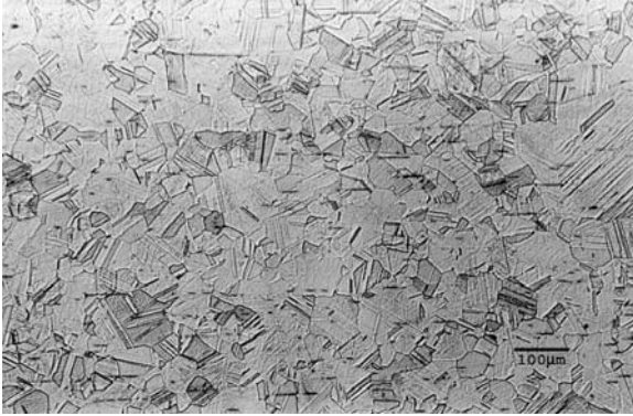
Figura 1 - Amostra A, 1050°C/40min., TG=60µm.
