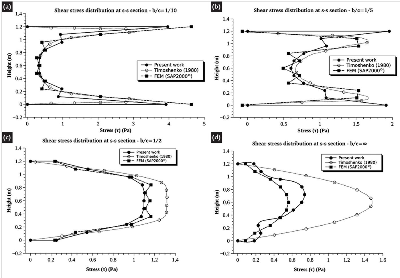
Figure 2 - Numerical and analytical shear stress for Example 1: (a)  $b/c=1/10$ ; (b)  $b/c=1/5$ ; (c)  $b/c=1/2$ ; (d)  $b/c=\infty$ .
