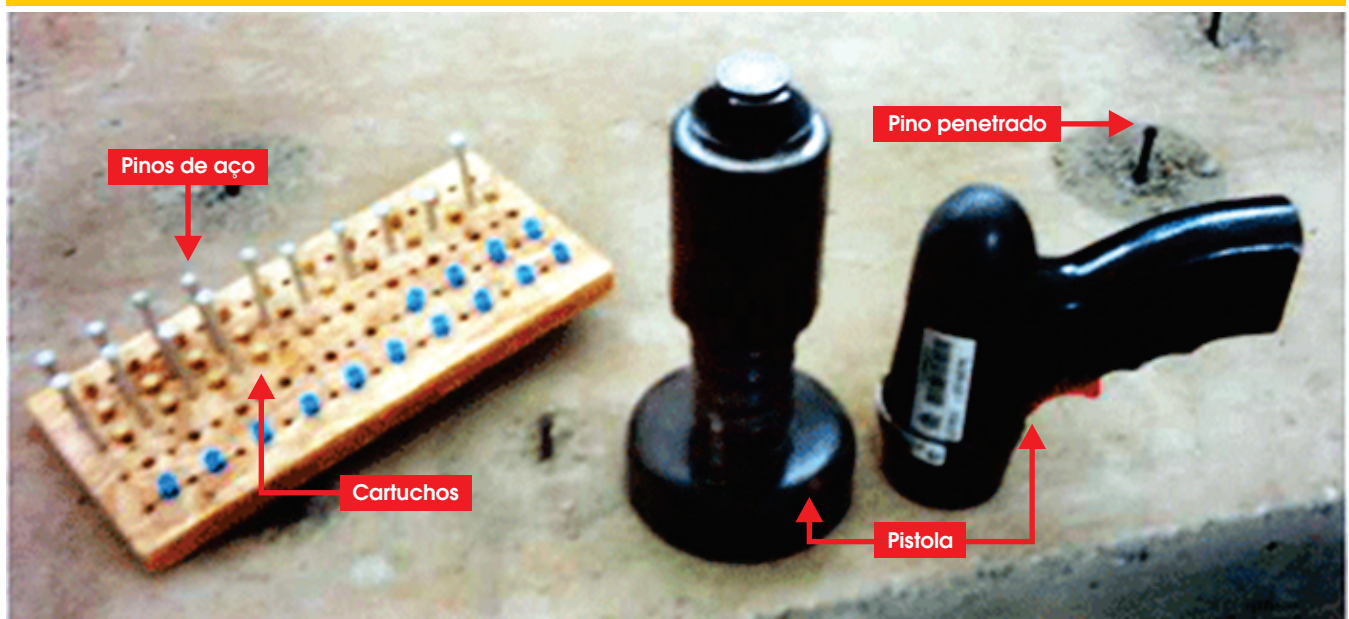
Figura 2 –Equipamentos utilizados no ensaio de penetração de pinos: pistola, pinos, cartuchos (pólvora)
