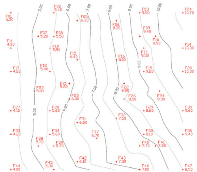
Figura 13 Curva de isorecalque do modelo CASCA ISE
