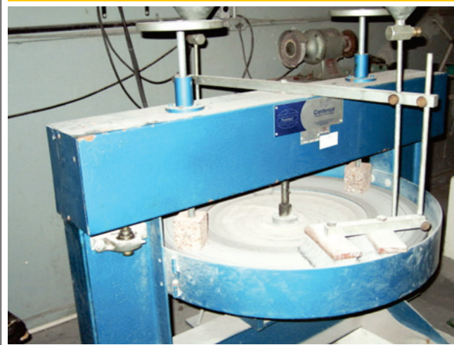
Figura 7 – Aparelho de ensaio de desgaste por abrasão
