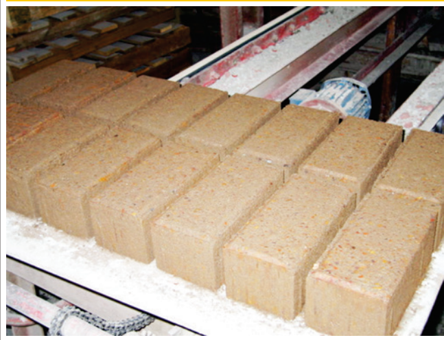
Figura 9 – Peças do bloquete Paver 8 produzidas com o rejeito de sinter feed
