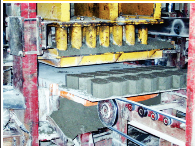
Figura 5 – Vibroprensa em etapa da produção dos bloquetes
