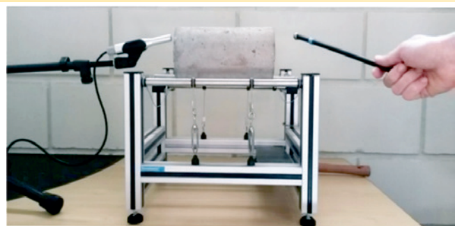
Figura 5 Corpo de prova posicionado e sendo solicitado para o ensaio
