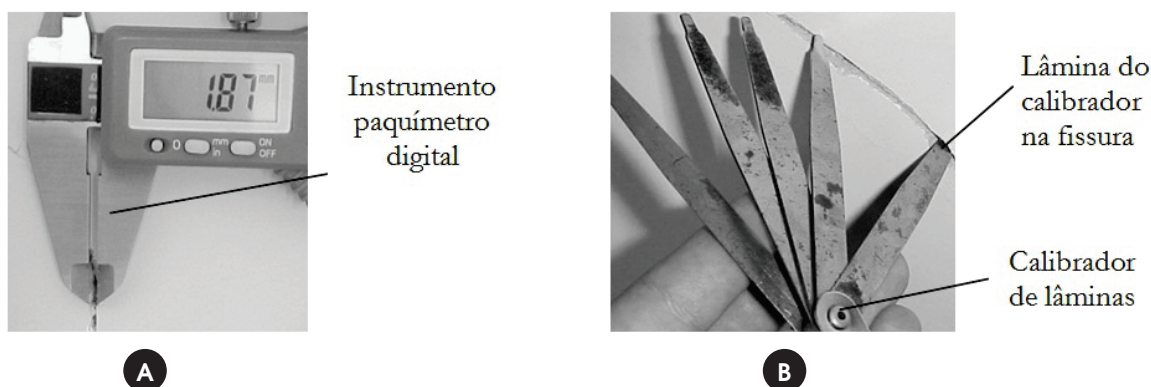
Figura 2 – (a) Instrumento paquímetro digital num procedimento de medição convencional da fissura em alvenaria. Figura 2 (b). Instrumento calibrador formado por lâminas. Este instrumento numa medição convencional permite uma verificação comparativa entre a abertura da fissura em alvenaria e a espessura da lâmina
