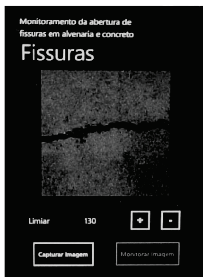
Figura 10 – Processamento de uma imagem no aparelho celular com o sistema Windows Phone: (a) Seleção do sistema de captura de imagem a ser processada (wPhoneFissuras); (b) Seleção do sistema (tela inicial) e do limiar para o processamento da imagem a ser capturada; (c) Processamento (monitoramento) da imagem capturada; (d) Imagem binária da fissura e a apresentação do resultado dos pixels monitorados da imagem
