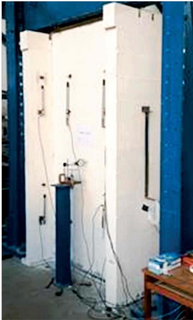
Figura 6 – Parede com flanges instrumentada e detalhe do pórtico de reação
