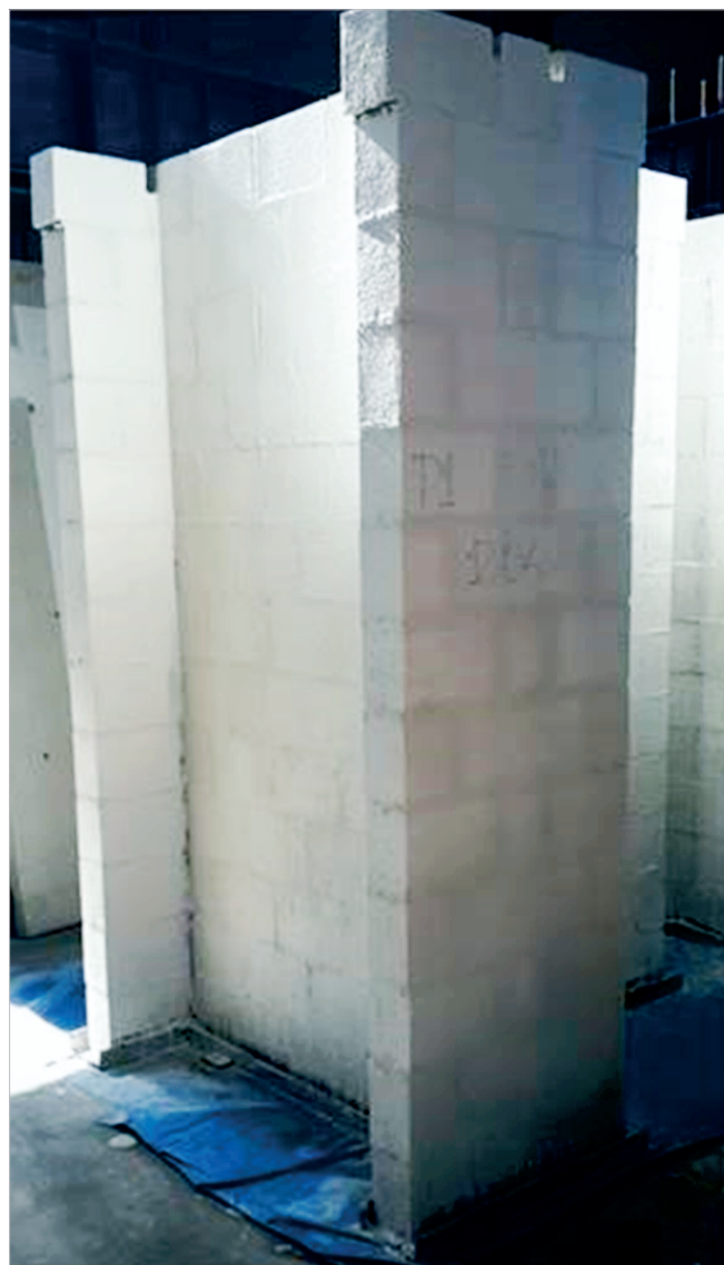
Figura 3 – Parede com flanges executada e sua movimentação em ponte rolante para o pórtico de reação
