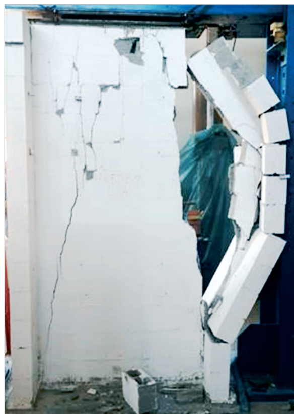
Figura 13 - Ruptura - Parede com flanges com apoio central 02
