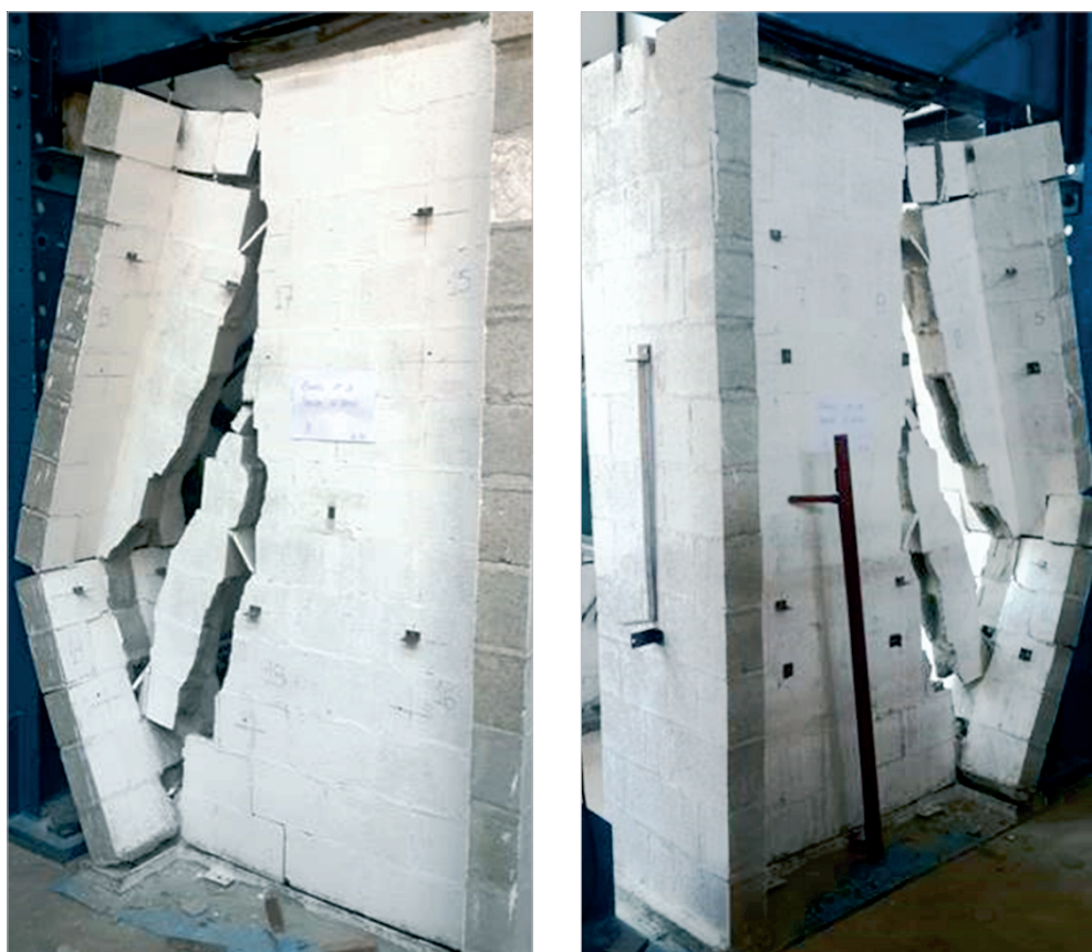
Figura 17 - Ruptura - Parede com flanges sem apoio central 06
