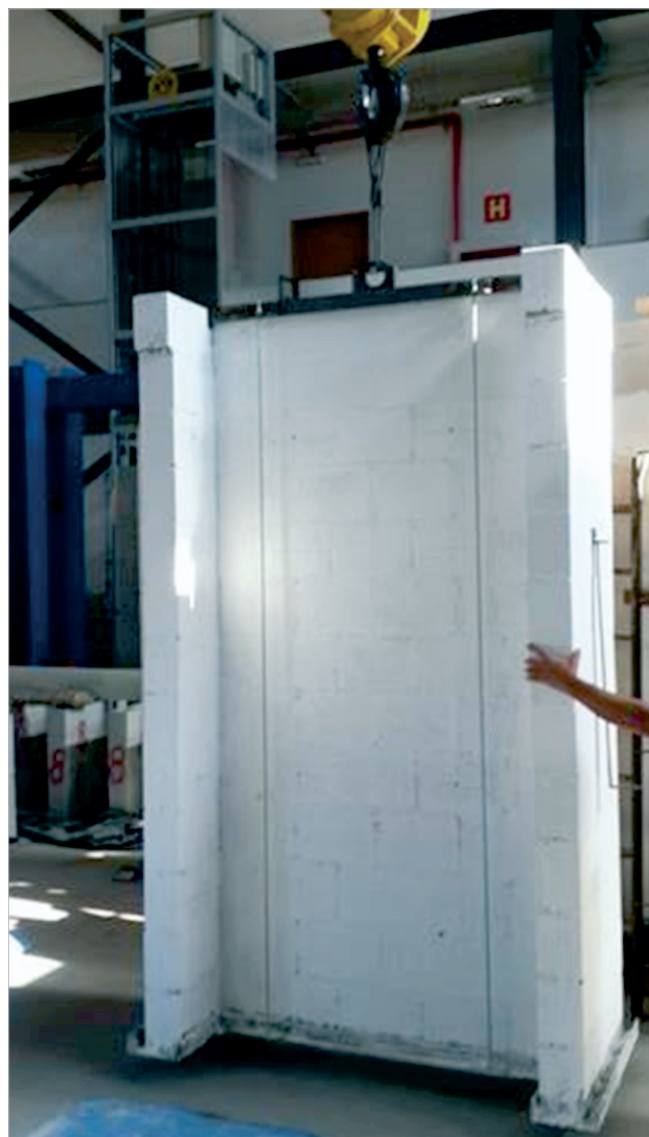
Figura 3 – Parede com flanges executada e sua movimentação em ponte rolante para o pórtico de reação
