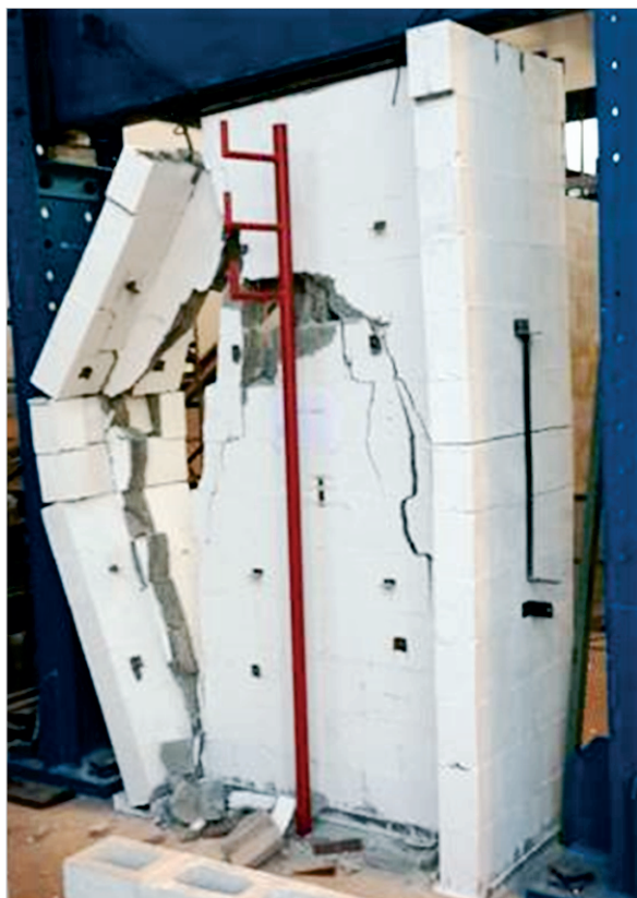
Figura 12 - Ruptura - Parede com flanges com apoio central 01
