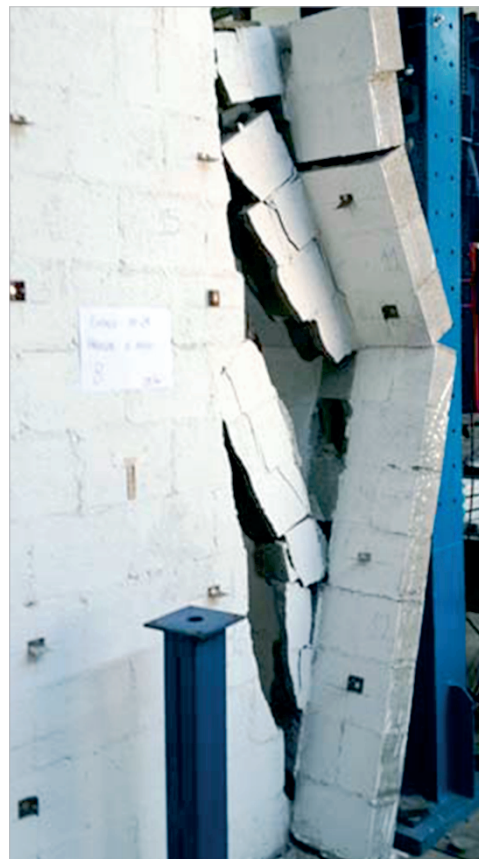
Figura 15 - Ruptura - Parede com flanges sem apoio central 04
