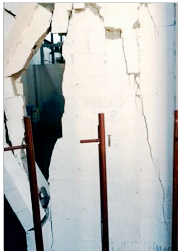
Figura 13 - Ruptura - Parede com flanges com apoio central 02
