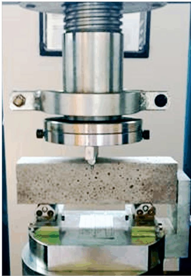
Figura 9 – Ensaio em corpos de prova prismáticos de argamassa, à flexão simples e à compressão
