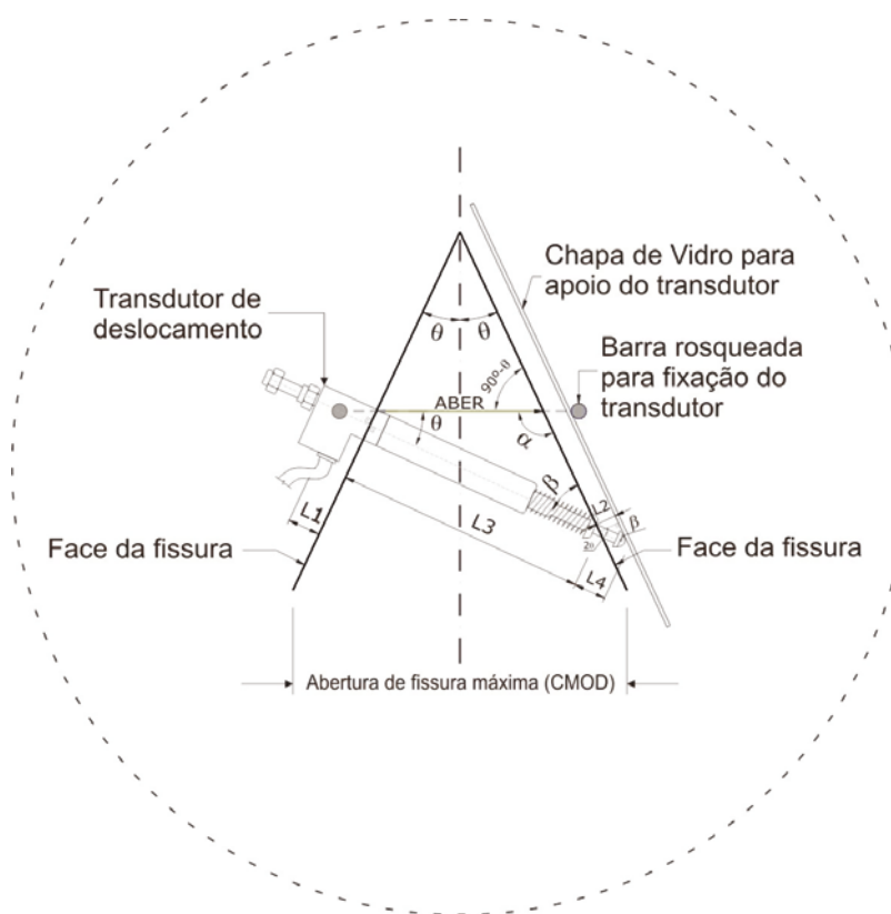
Figura 4 -Esquema de rotação dos transdutores de deslocamento de acordo com o deslocamento da viga
