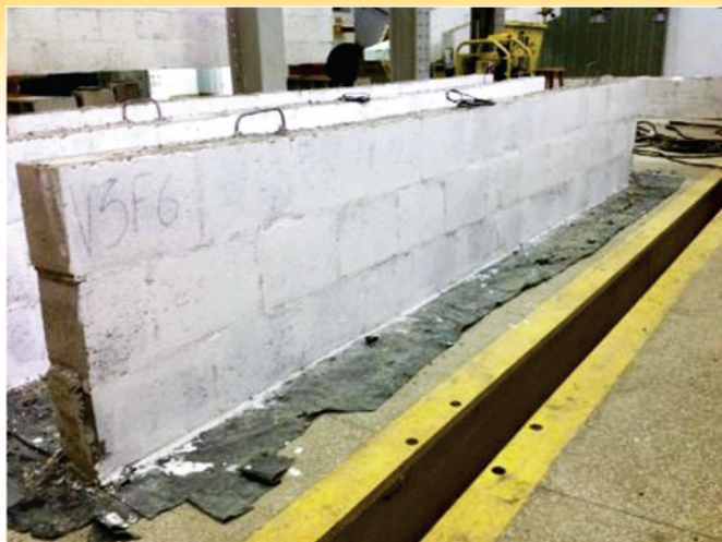
Figura 8 Viga de alvenaria estrutural após sua confecção
