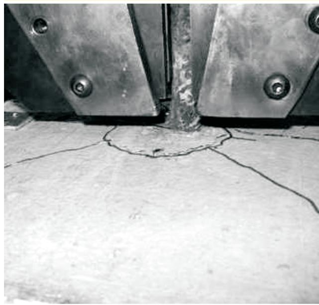
**Figura 11 – Configuração final de fissuras nas quatro faces do tirante de concreto reforçado com 0,75% de fibras sem adições minerais**
