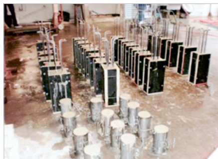
Moldagem das estacas
