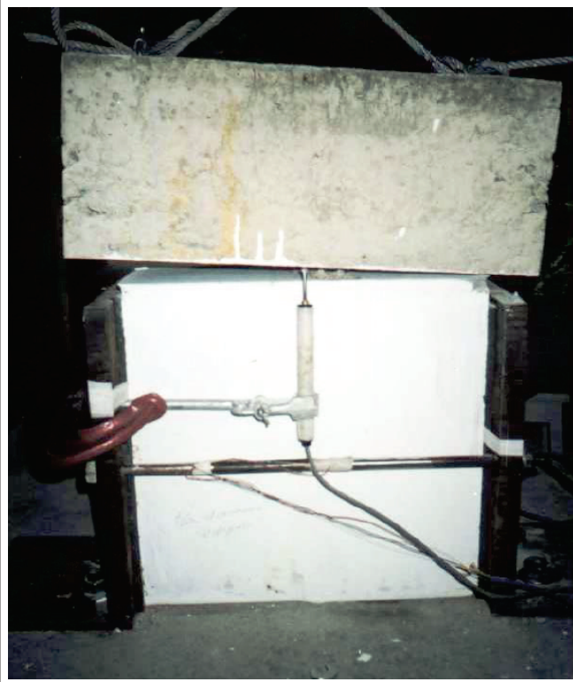
Figura 12 – Detalhe típico de ruptura do modelo sem tratamento da face do pilar com argamassa aditivada
