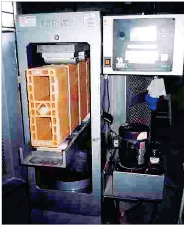
Figura 9 – Detalhe do ensaio de avaliação da resistência de aderência da argamassa na flexão. prisma de blocos cerâmicos posicionado para o ensaio
