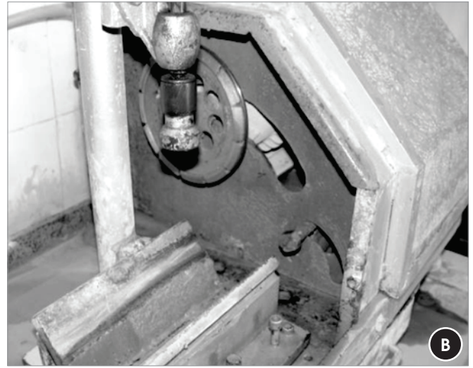
Figura 2 – Corpo de prova sendo retificado com retífica tipo RRDF (B) e disco fino diamantado à esquerda (A)
