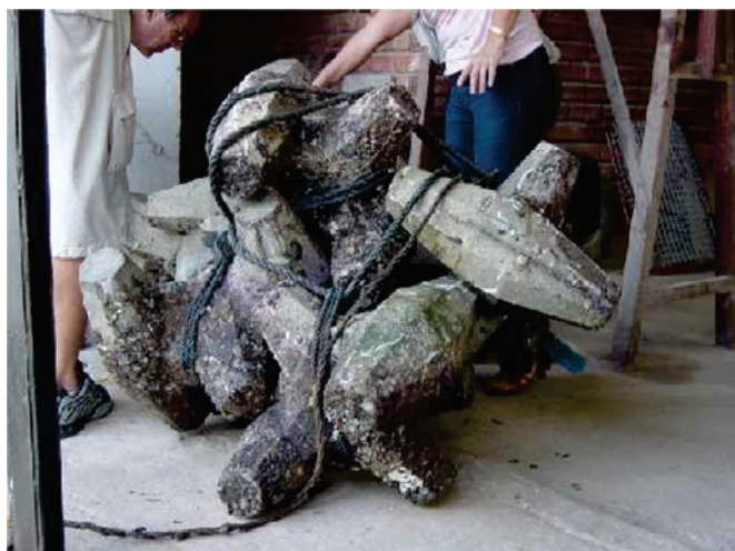
Figura 7 Componentes retirados do ambiente marinho, após 1 ano
