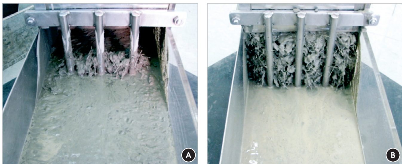
Figura 7 – Resultado após ensaio da Caixa L para os teores de fibras de 80 kg/m 3 (a) e 120 kg/m 3 (b)
