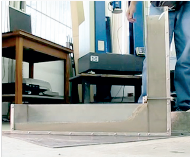
Figura 4 – Caixa L após realização do ensaio
