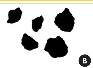
Figura 2 – Imagens para análise da influência da preparação das amostras: (a) 0,6 mm aleatória, antes e depois do tratamento e (b) 0,6 mm orientada, antes e depois do tratamento
