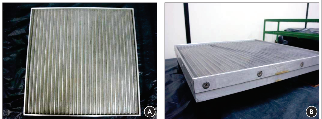
Figura 4 – Placa de fissuração de argamassa - (a) vista superior; (b) vista lateral
