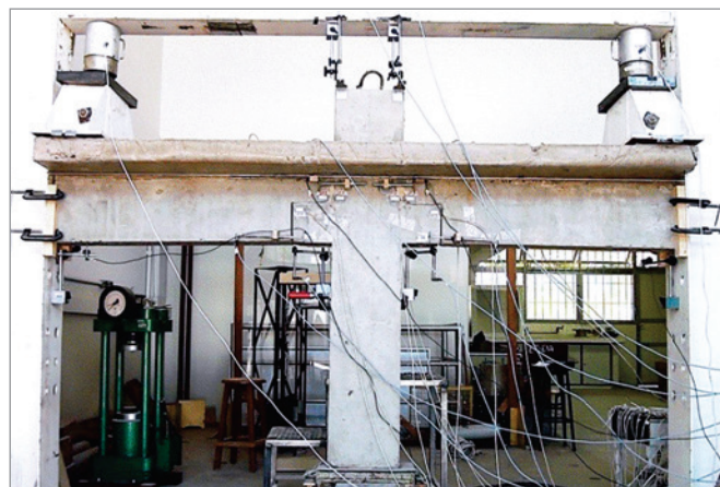
Figura 17 Vista frontal: dispositivos de medição de deformações, deslocamentos e forças
