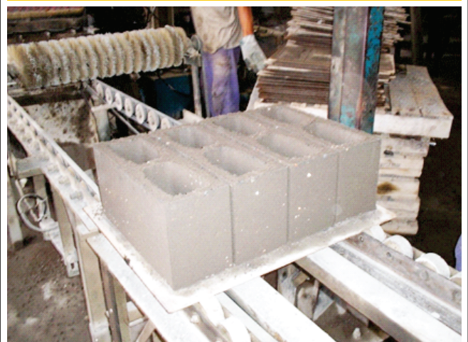
Figura 4 – Blocos de concreto moldados
