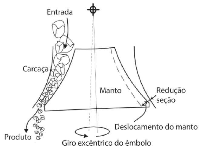
Figura 2 Detalhe de funcionamento do britador Cônico (adaptado de Itävuo et al. [8])
