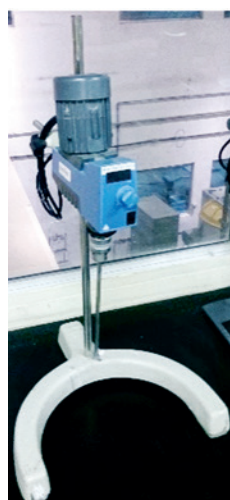
Figura 3.2 Agitador mecânico IKA RW20 (esquerda) e condições de mistura utilizadas (direita)
