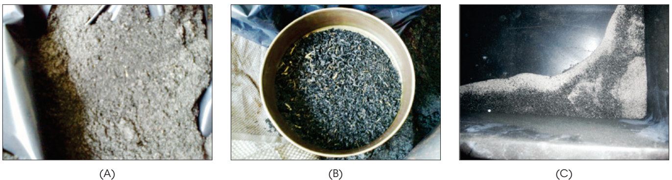
Figura 2 Aspecto visual da amostra de CBC: (A) CBC no estado bruto; (B) Material retirado da CBC; (C) Cinza peneirada
