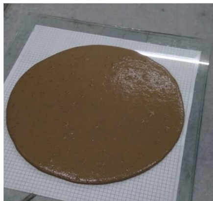
Figure 6. Mini Slump experiment.
